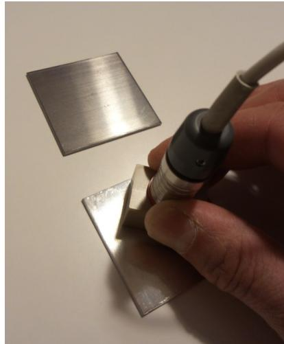
Aplicati sonda pe foaia de aluminiu (cea de culoare gri deschis).
