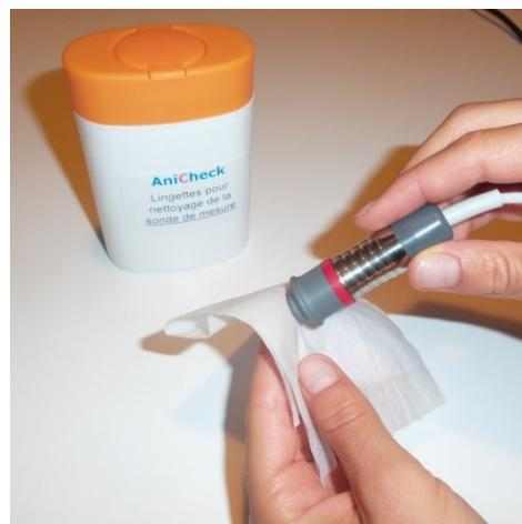
Curatati sonda dupa masurare cu servetelul din kit-ul primit.
