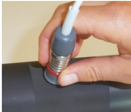
Efectuati prima masuratoare fara a aplica tus pe suprafata anilox fara a folosi FerroFluid
