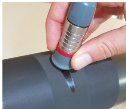
Efectuati a doua masuratoare a suprafetei anilox cu lichidul Ferrofluid aplicat
