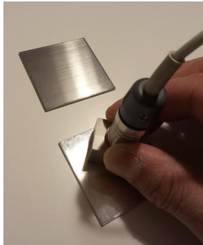
Aplicati sonda de inca 4 ori (in asa fel incat sa fie 5 masuratori in total).
