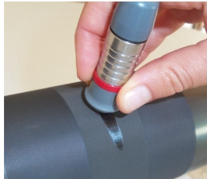
Efectuati prima masuratoare a suprafetei anilox cu lichidul Ferrofluid aplicat.
