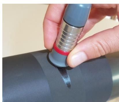
Efectuati a treia masuratoare a suprafetei anilox cu lichidul Ferrofluid aplicat.
